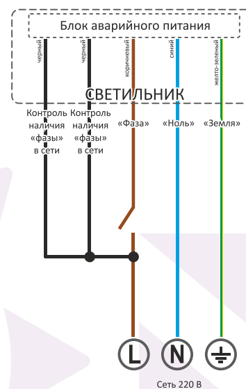
Схема подключения светильника с блоком аварийного питания (БАП) пятипроводная
